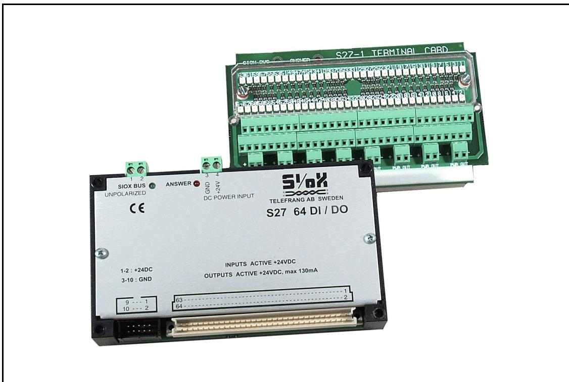
64 digitala, valbara in-/utgångar har kunnat packas i en mycket kompakt enhet för alla slags övervaknings- och styruppgifter. Genom en inbyggd PLC kan exempelvis 32 utgångar styra multiplexavläsning på 32 ingångar = 1024 larmkontakter. Två S27 kan mellan sig överföra 64 signaler på bara två trådar.
